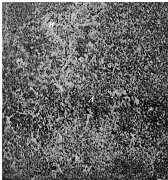
Рис. 1. Рентгеновская топограмма исходного образца размером 12 \times 12 \text{ мм}^2 . Излучение \text{CuK}\alpha_1 , отражение (11\bar{2}.12) . Видны области с равномерным распределением базисных дислокаций (A) и с сильными локальными нарушениями (B).
