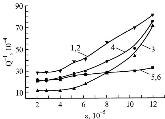
Амплитудные зависимости ВТ алюминия (99.999%) в обычных условиях измерений (1, 3, 5) и во время воздействия ИСМП (2, 4, 6) для исходного рекристаллизованного (1, 2), закаленного и состаренного (3, 4), отпущенного (5, 6) состояний материала.
