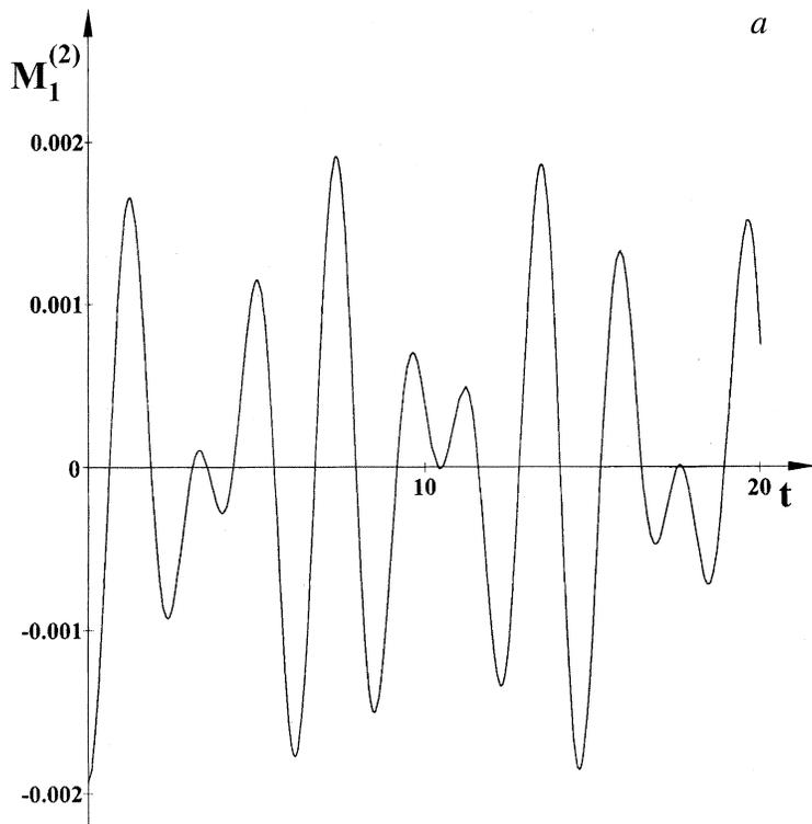
Зависимость безразмерной амплитуды  $M_1^{(2)}$  осцилляций трансляционной ( $n = 1$ ) моды капли от безразмерного времени  $t$ , когда начальная деформация исходной равновесной сферической формы задана в виде:  $a = \varepsilon[P_2(\mu) + P_3(\mu)]/2$ ;  $b = \varepsilon[P_{10}(\mu) + P_{11}(\mu)]/2$ .
