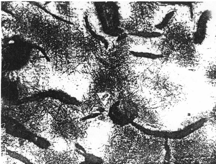
**Рис. 1.** Фотография микроструктуры зоны лазерного воздействия с углеродными глобулами (увеличение 400).
