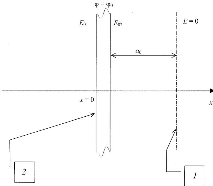
**Рис. 1.** Геометрия задачи о двух пластинах, окруженных облаком электронов или помещенных в плазму: 1 — ось симметрии; 2 — пластинка под заданным потенциалом.
