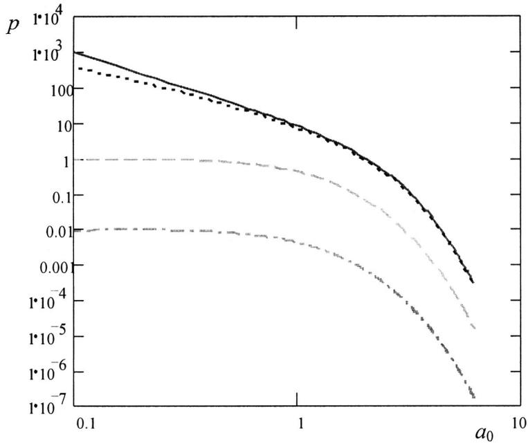
**Рис. 5.** Зависимость электростатического давления  $p$  от половины расстояния между плоскостями  $a_0$  при  $\delta = 1$ ;  $\varphi_0 \rightarrow \infty$ ,  $n_{e0} \rightarrow \infty$  — сплошная кривая,  $\varphi_0 = 7$ ,  $n_{e0} = 10^3$  — пунктир;  $\varphi_0 = 1$ ,  $n_{e0} = 2.7$  — штрихи;  $\varphi_0 = 0.1$ ,  $n_{e0} = 0.1$  — штрихпунктир.
