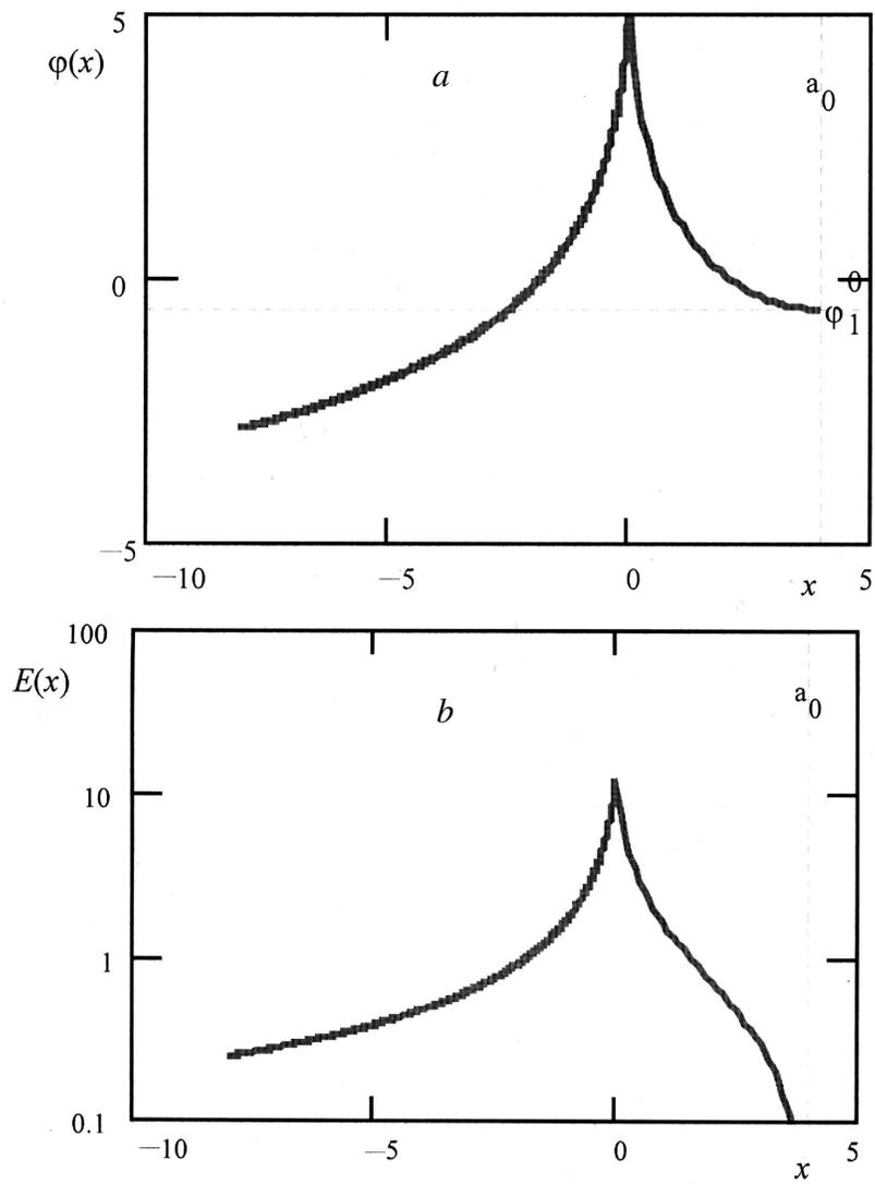
**Рис. 2.** Зависимость потенциала ( $a$ ) и напряженности поля ( $b$ ) от координаты в задаче о двух пластинах при  $\delta = 0$ ,  $a_0 = 4$ ,  $\varphi_0 = 5$ .
