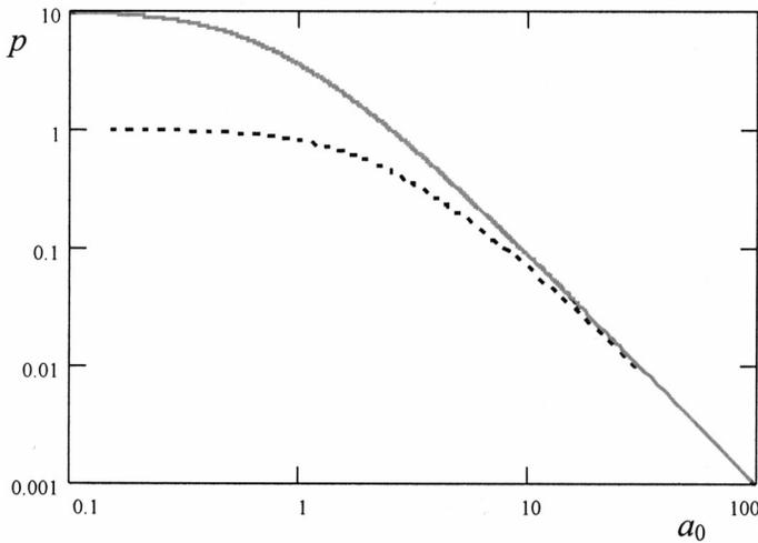
**Рис. 4.** Зависимость электростатического давления  $p$  от половины расстояния между плоскостями  $a_0$  при  $\delta = 0$ ;  $n_{e0} = 10$  — сплошная кривая,  $n_{e0} = 1$  — пунктир.
