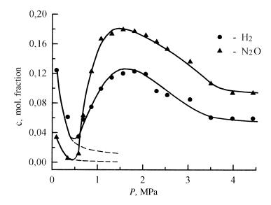
Количества перешедших водорода и закиси азота в азот из верхней колбы аппарата в нижнюю при различных типах смешения в зависимости от давления. Точки — экспериментальные данные. Сплошные линии — обработка результатов полиномами различной степени. Пунктирные линии — расчет в предположении диффузии.
