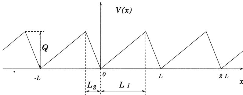
**Рис. 1.** Кусочно-линейный периодический потенциал  $V(x)$ :  $L$  — период потенциала,  $L_1$  — длина пологого склона потенциала,  $L_2$  — длина крутого склона потенциала,  $Q$  — высота потенциальных барьеров. Связь между параметрами потенциала следующая:  $a = Q/L_1$ ,  $b = Q/L_2$ .
