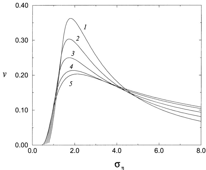
**Рис. 2.** График зависимостей средних скоростей  $v$  от интенсивности случайной силы  $\sigma_\eta$ . Параметры:  $L = 2\pi$ ,  $a = 1$ ,  $b = 2$ . Кривым, обозначенным цифрами 1–5, соответствуют значения параметра  $\alpha$ , равные  $1/A^2$ ,  $1/(2A^2)$ ,  $0$ ,  $-1/(2A^2)$ ,  $-1/A^2$ .
