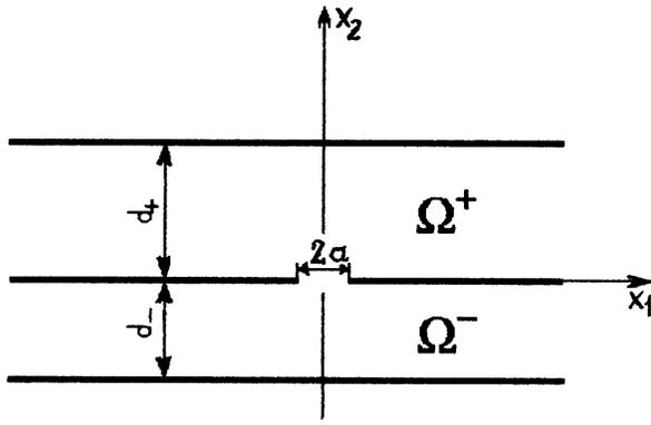
Геометрическая конфигурация системы.  $d_{\pm}$  — ширина волновода  $\Omega_{\pm}$ ,  $2a$  — ширина отверстия связи. Указан выбор системы координат.
