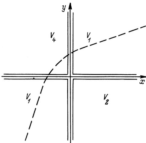
Рис. 2. Ход осевой траектории пучка в четырехэлектродной электростатической системе, используемой в качестве призмы.
