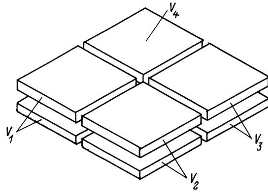
Рис. 1. Четырехэлектродная электростатическая система.
