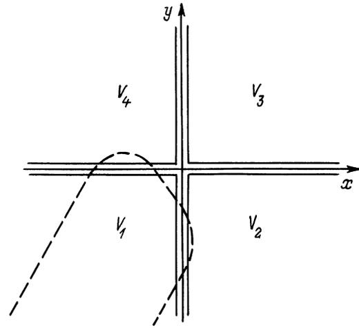
Рис. 3. Ход осевой траектории пучка в четырехэлектродной электростатической системе, используемой в качестве зеркала.
