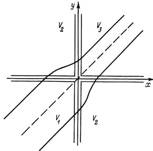
Рис. 4. Ход траекторий пучка в четырехэлектродной электростатической системе, используемой в качестве линзы с прямой осью.
