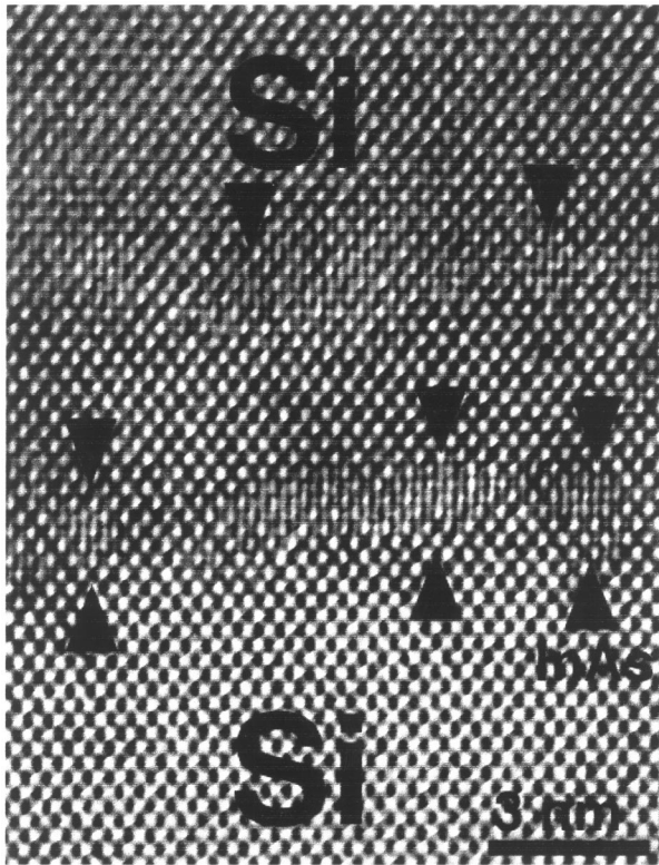
Рис. 5. ТЭМ изображение поперечного сечения образца В, снятое в режиме высокого разрешения. Стрелками отмечены кластеры InAs.
