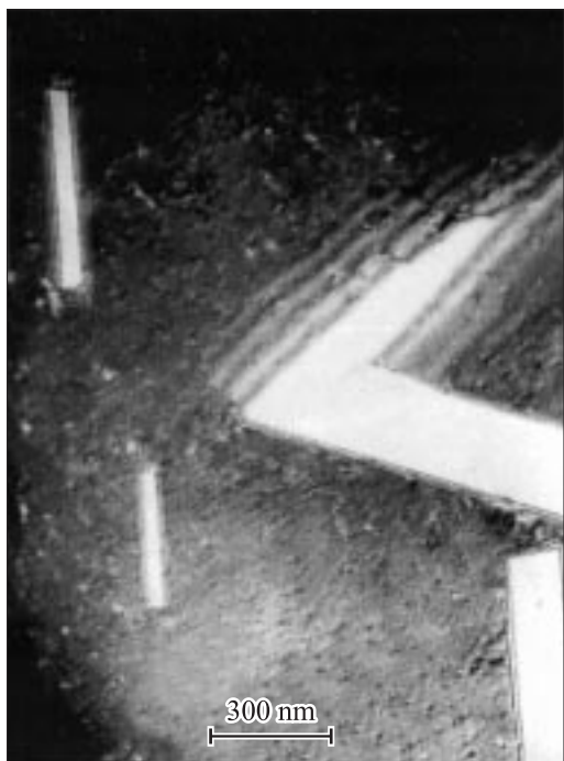
Рис. 2. Двойники (вытянутые прямоугольники) в образце упорядоченного монооксида титана \text{TiO}_{1.087} (просвечивающая электронная микроскопия, увеличение в 115 000 раз).
