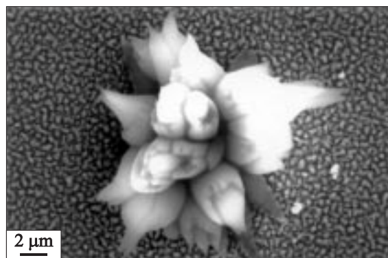
Рис. 3. Вид поверхности пленок олово-фуллерит после хранения на воздухе.
