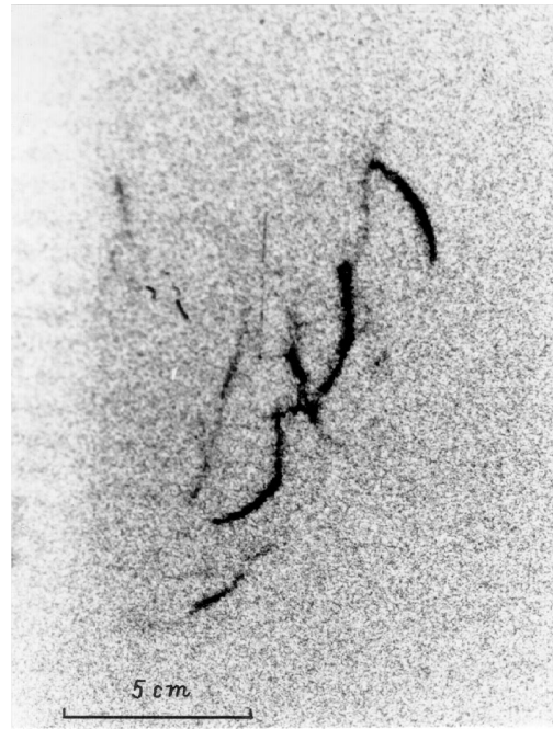
Рис. 6. Иницированный СВЧ разряд при p = 330 Torr и E_0 = 4.4 \text{ kV/cm} ; t_{ex} = 1.5 \mu\text{s} , время от начала разряда 10 \mu\text{s} .
