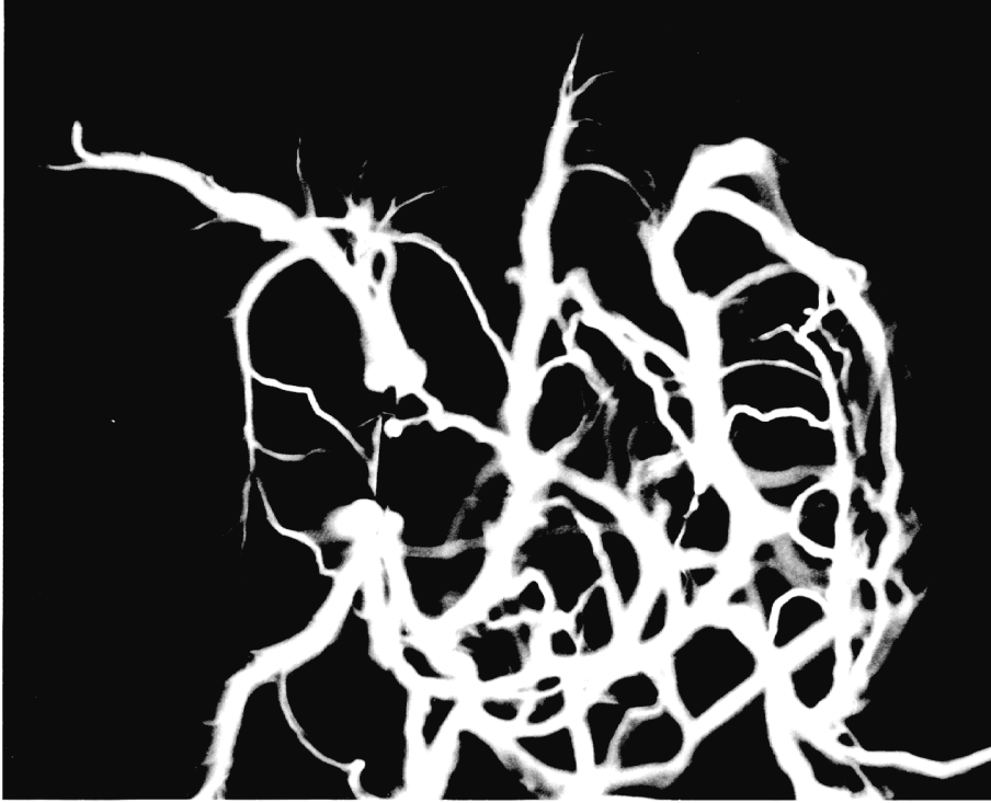
Рис. 1. Подкритичный СВЧ разряд при p = 760 Torr, E_0 = 3 kV/cm и t_{\text{pul}} = 40 \mu s. Иницирован проводником 2L = 10 mm и 2a = 0.8 mm, \Psi = 9 , расчетное E_{\text{out}} = 27 kV/cm.
