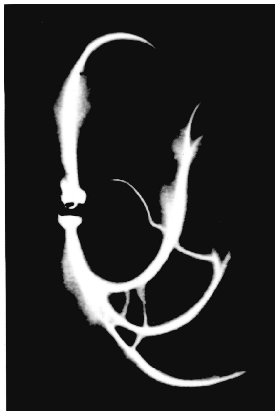
Рис. 5. СВЧ разряд при p = 120 \text{ Torr} , E_0 = 2.5 \text{ kV/cm} и t_{\text{pul}} = 7 \mu\text{s} . Иницирован шаром, 2a = 2.5 \text{ mm} .
