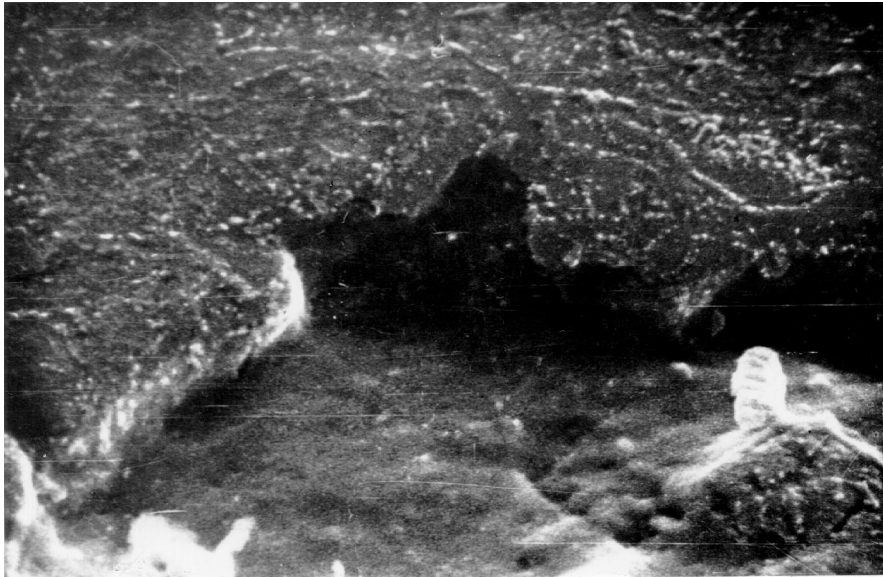
Рис. 5. Фрактограмма участка откольной поверхности типа лепестка Коха.
