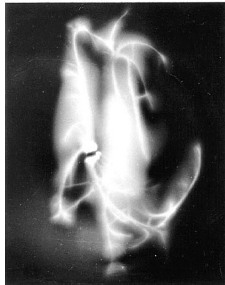
Рис. 6. СВЧ разряд в гелии при p = 760 Торг и E_0 = 5.5 кВ/см.
