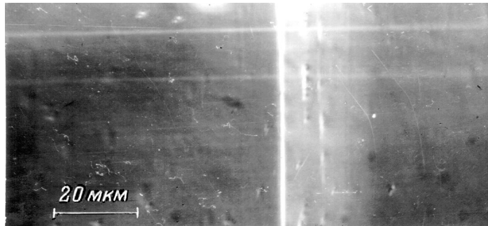
Рис. 3. Оптическая микрофотография участка поверхности структуры GaAs/AlGaAs, полученная с помощью дифракционно-контрастной приставки Номарского. Горизонтальные линии сверху — ступени, образованные полосами скольжения в плоскостях (111). Вертикальная область в центре — фотолитографический рельеф с пологим склоном, сформированный до генерации полос скольжения.
