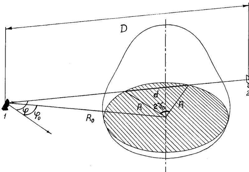
Принцип определения параметров газовых образований в атмосфере: 1 — радиолокационная станция, 2 — репер.
