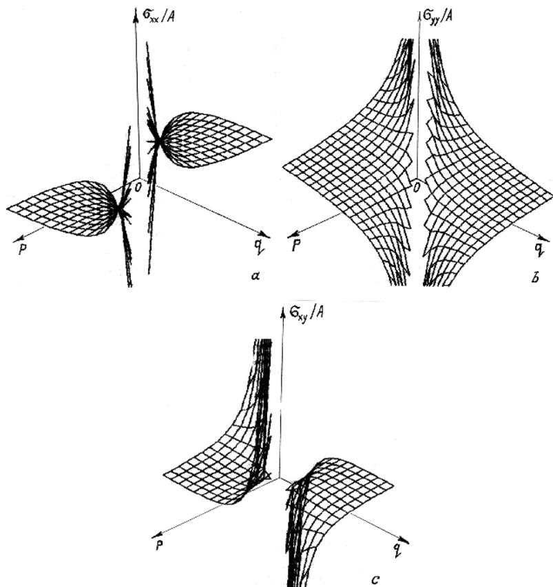
**Рис. 2.** Зависимость величины  $\sigma_{ij}/A$  от  $p$  и  $q$ :  $a - \sigma_{xx}/A$ ;  $b - \sigma_{yy}/A$ ;  $c - \sigma_{xy}/A$ .
