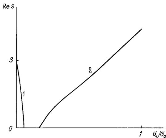
Зависимости вещественной  $\text{Re } s = \text{Re } s(\sigma_1/\sigma_2)$  компоненты комплексной частоты от отношения удельных проводимостей верхней  $\sigma_1$  и нижней  $\sigma_2$  жидкостей при  $k = 1$ ,  $\nu = 0.1$ ,  $\varepsilon = 0.1$ ,  $\rho = 0.01$ ,  $\beta = 0.01$ ,  $W = 2.15$ .
