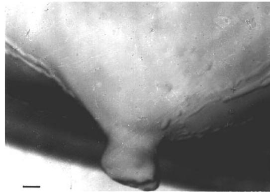
Рис. 7. Микроострие, вытянутое из Та полем высокого напряжения.
