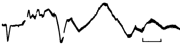
Рис. 5. Интерферограмма предвестника в стивлоне с объемной концентрацией \beta = 32\% (одна клетка — 500 нс).
