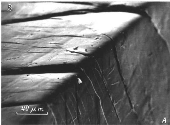
**Рис. 1.** РЭМ-изображение деформированного рельефа на поверхности образца после одноосного сжатия.
