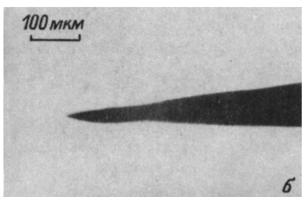
Рис. 1. Этапы изготовления образцов-острий из монокристаллов YBa_2Cu_3O_{7-x} :
