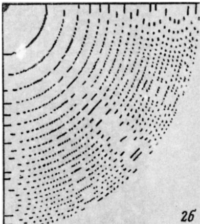
Рис. 2. а - ионное изображение области куба (001). V=11 кВ; разрешение атомов в направлении 100 составляет 3,8 \text{ \AA} . б - смоделированное изображение области куба (001) подрешетки иттрия.
