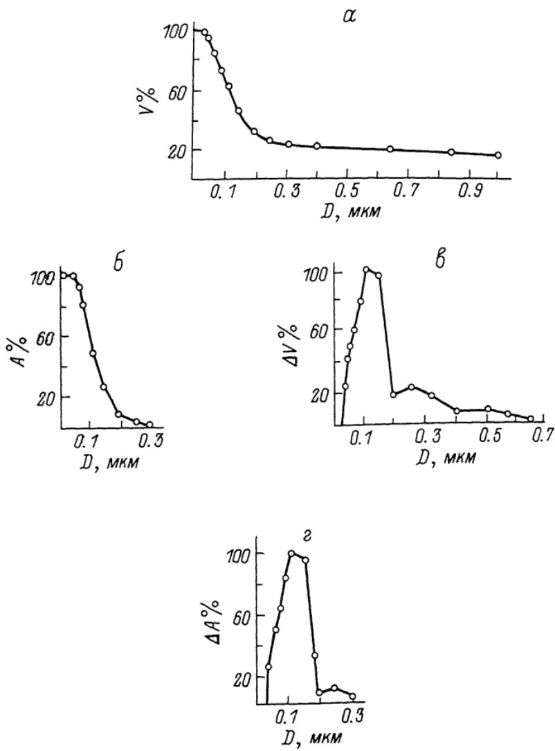
а — зависимость суммарного объема пор  $V\%$  от их диаметра (в  $\mu\text{мкм}$ ); 100% ордината соответствует общему объему пор, в которые проникла ртуть при максимальном приложенном давлении.
