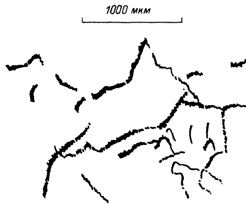
Рис. 2. Форма дефектов в пластине \varnothing 82 мм после ТО при \rho=300 Ом·см.
