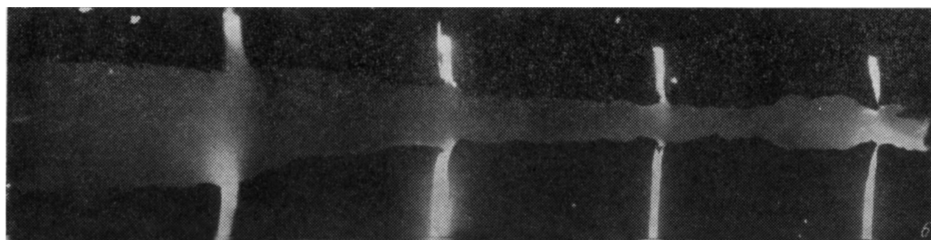
Рис. 3. Автордиограммы кавермы с реперными прокладками, содержащими изотоп ^{14}\text{C} (а) и изотоп ^{119}\text{Sn} (б).
