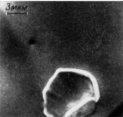
Рис. 4. Микрофотография поверхности анода, полученная после одного разряда.
