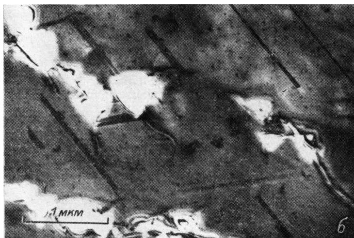
Рис. 5. Электронно-микроскопические снимки слоев InGaAsSb, демонстрирующие увеличение плотности ДУ с ростом деформации.
