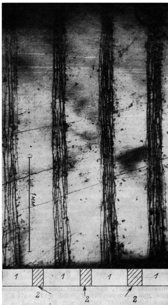
Рис. 3. Грань (010) после высокотемпературной деформации. Волнистые ступени соответствуют выходам полос локализованного сдвига (ПЛС) на винтовую грань.
