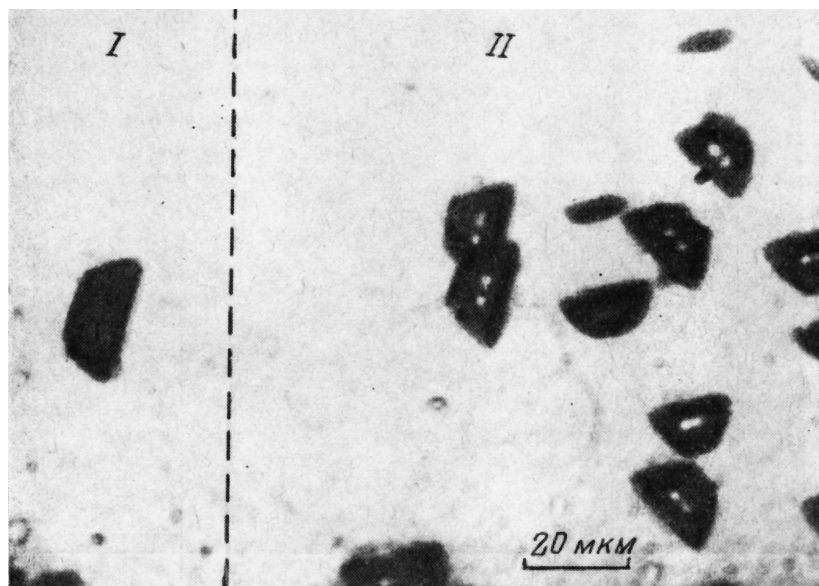
Рис. 2. Дислокационные петли с дефектом упаковки, образовавшиеся после диффузии золота в пластине из кристалла 2, прошедшей предварительную термообработку при 900 °С.
