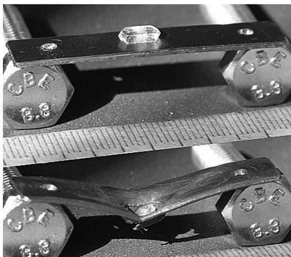
Рис. 6. Фотография образца и медной подложки до и после детонации, зафиксированной на рис. 2, в вакуумной камере ускорителя электронов.
