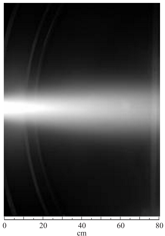
Рис. 2. Фотография плазмы, выделяющейся в момент разрушения кристалла кварца.
