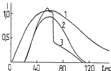
Временная зависимость напряженности магнитного поля (1) и интенсивности СИ (2,3) при максимальной энергии электронов около 40 МэВ.
