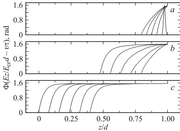
**Рис. 3.** Три стадии эволюции азимутального угла  $\Phi(q)$  в НТЯ рассчитанные с помощью уравнения (4) и граничных условий (6), параметр  $Ak \sin(2\Delta\Phi)/2K_2 = 1.0$ , электрическое поле  $E/E_{cr} = 10$ .
