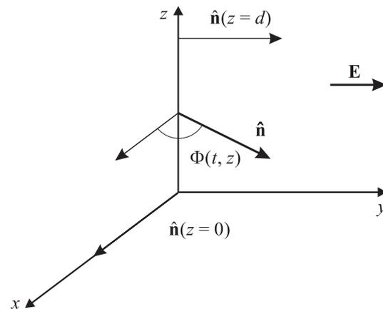
Рис. 1. Геометрия нематической твистовой ячейки.
