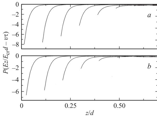
**Рис. 5.** Эволюция профиля давления  $P$  от верхней поверхности ячейки к нижней, рассчитанная с помощью выражения (7) для двух режимов релаксации.  $a$  — жесткое сцепление (5),  $b$  — слабое сцепление (6) молекул ЖК с обеими поверхностями НТЯ. В обоих случаях  $E/E_{cr} = 10$ , а начальное возмущение директора инициировано вблизи верхней границы НТЯ,  $q_3 = 9.75$ .
