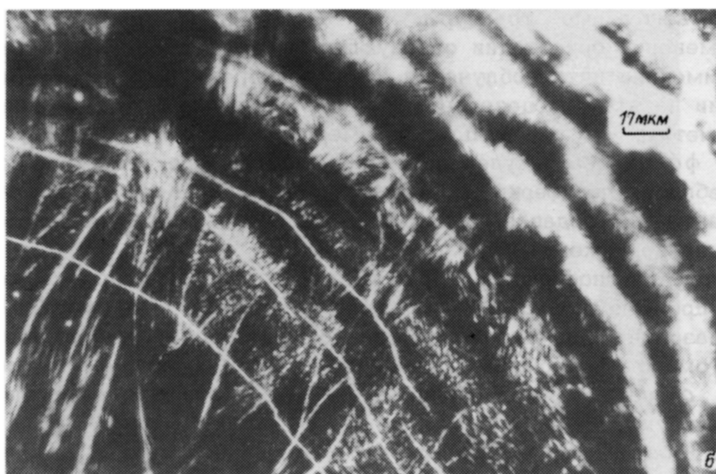
Рис. 2. Микрорельеф на поверхности анодированного титана, сформированный под действием излучения импульса свободной генерации неодимового лазера в атмосфере кислорода при нормальном давлении и плотности мощности q = 1.4 \cdot 10^5 \text{ Вт/см}^2 : а - общий вид, б - зона кольцевых структур с большим увеличением.
