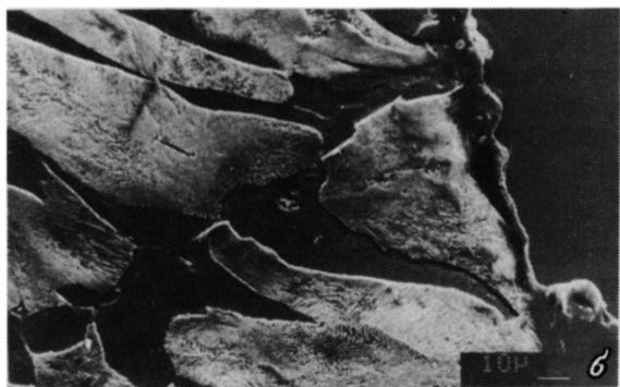
Рис. 2. Структура границы: а - Fe-Ti , б - Fe-Cu . Обработка пакета производилась частицами NbV .
