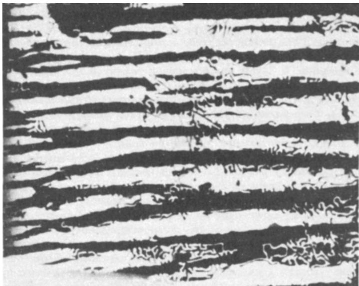
Рис. 2. Доменная структура пластины гексаферрита бария (толщиной 0.4 мм) с легкой осью, лежащей в плоскости пластины. Размер поля зрения поперек полосовых доменов составляет \approx 3 мм.
