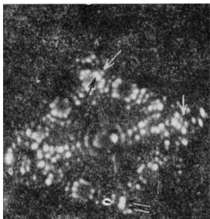
Рис. 3. Автоионное изображение образца из технически чистого вольфрама, облученного ионами \text{La}^+ с энергией 30 кэВ флюенсом 10^{19} ион/ \text{м}^2 , полученное после нагрева образца до \sim 1200 К при синхронном снижении его потенциала.
