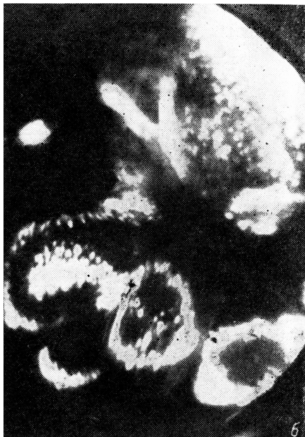
Рис. 5. Автоионные изображения поверхностей разрыва трех вольфрамовых образцов-острий.
