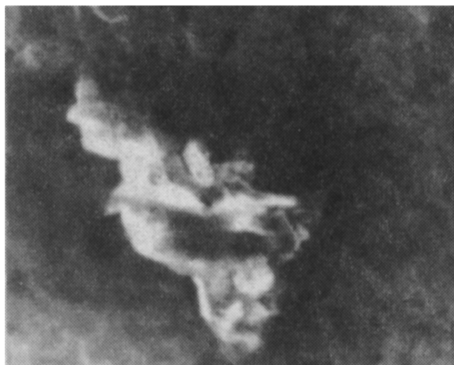
Рис. 4. Микроструктура включений, полученная в электронном микроскопе, \times 2600 .
