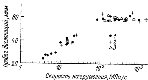
Рис. 4. Зависимость отнормированных длин пробегов дислокаций от скорости нагружения при T=295 (1, 3) и 77 \text{ К} (2). 1 - \tau > 0.65 \text{ МПа}, 2 - \tau > 0.8 \text{ МПа}, 3 - 150 \leq \leq P \leq 700 \text{ МПа} .
