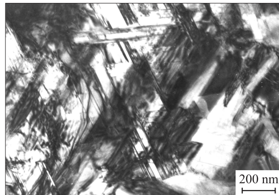
Рис. 7. Микроструктура кобальта после отжига НК-образца при 873 К в течение 20 min.
