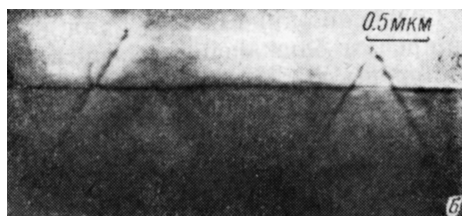
Рис. 5. Электронно-микроскопические изображения дислокационных сеток в ДГС на первой (а) и второй (б) гетерограницах.
