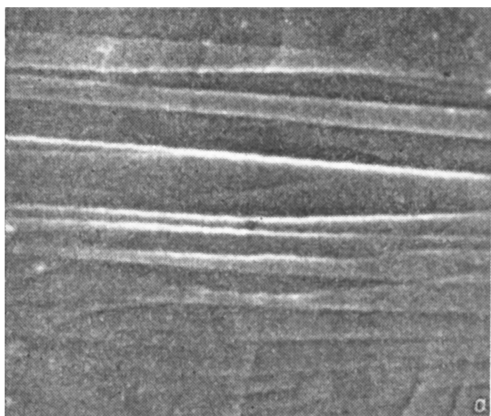
Рис. 4. Полосы сдвига, возникающие при прокатке MC Ni 60 Nb 40 на поверхности ленты, \times 2000 (а), и боковой стороне, \times 2600 (б).
