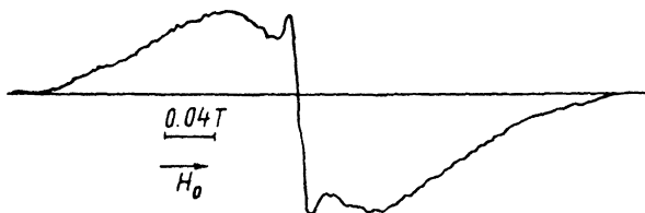
Рис. 1. Спектр ЭПР ОВБ типа \gamma . \text{Li}_{0.95}\text{V}_2\text{O}_5 . T=200 К.
