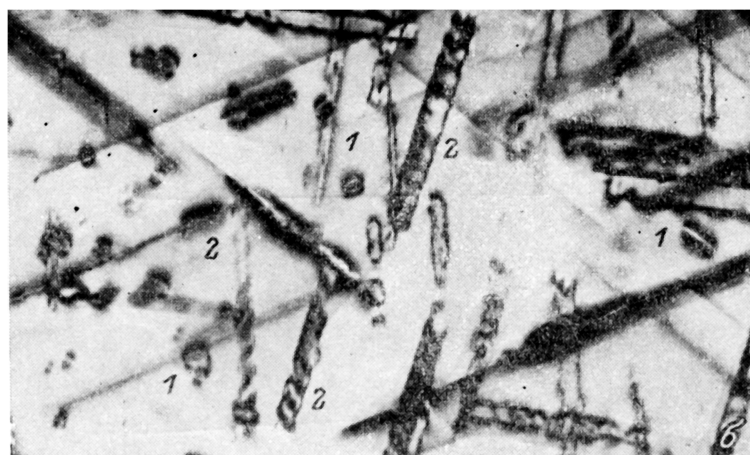
Рис. 4. Возникновение дислокационных петель (1) и {113}-дефектов (2) при облучении в ВЭМ кристаллов Si(P) с N_P = 1 \cdot 10^{19} см -3 при T = 600 °C.
