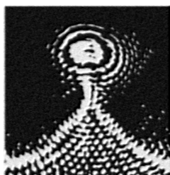
Рис. 1. Эволюция интерференционной картины вблизи точки возврата каустики типа сборки Уитни и опорного гауссового пучка.
