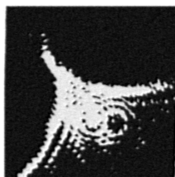
Рис. 1. Эволюция интерференционной картины вблизи точки возврата каустики типа сборки Уитни и опорного гауссового пучка.
