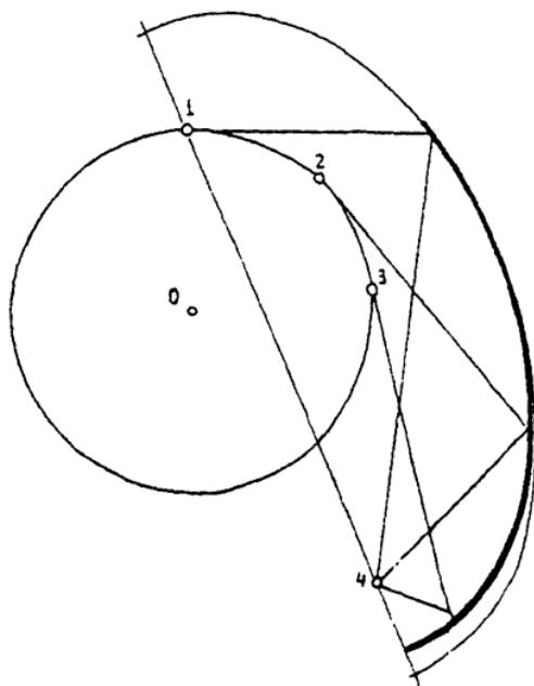
Геометрическая схема формирования квазиэллиптической изохронной фокусирующей поверхности. Тонкой линией показана часть эллипса с фокусами 1, 4 и эксцентриситетом, определяемым длиной нити.
