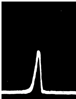
Рис. 1. Неструктурированная микроволновая фоновая мода ИИ при \Delta H = 0 , P = 4 мВт. Частота ИИ \Omega \approx 9.1 ГГц. Время экспозиции при фотосъемке t_{\text{ex}} = 1 с. Горизонтальная развертка спектроанализатора \Delta\Omega_{\text{sw}} = 10 кГц.
